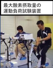
最大酸素摂取量の運動負荷試験装置
